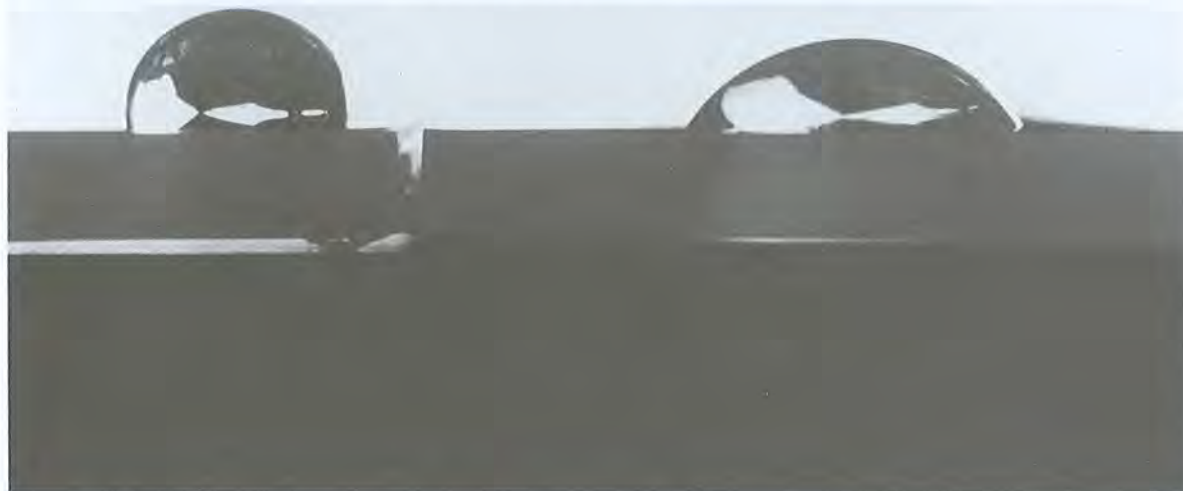
Abb. 3: Kontakwinkelmessung zur Bestimmung der Benetzbarkeit einer Substratoberfläche. Links: 25 \mu l Wasser auf unbehandeltem Polypropylen. Rechts: nach Plasmabehandlung ( O_2 Gas, p=2.3 mbar, 30 Sekunden). Für die Effekte auf die Adhäsion siehe Ref. 4.
